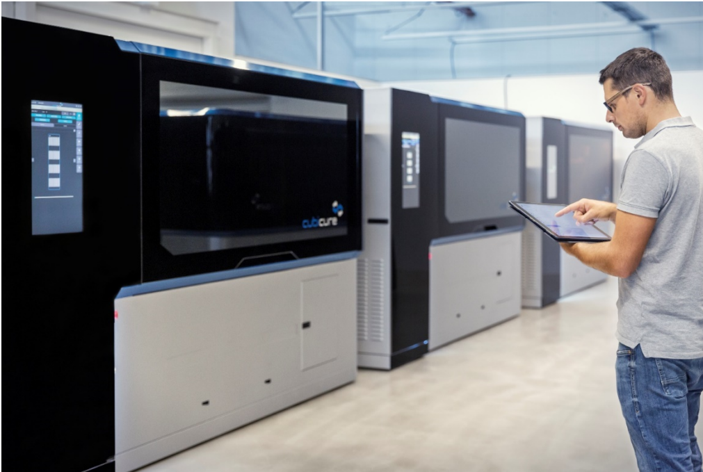
Mit der 3D-Druckanlage Cerion von Cubicure werden jetzt Kunststoffbauteile auf Knopfdruck und in Serie werkzeuglos gefertigt.
